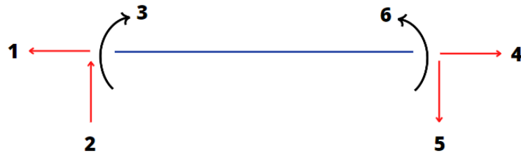
Figura 2: Graus de liberdade em um elemento plano de viga.
