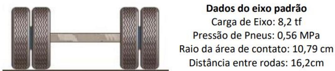
Figura 15 - Eixo padrão rodoviário assumido no software
